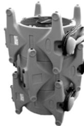
**Gestapelter Betrieb** - Einen Ace-Turbotrockner auf einer festen, ebenen Fläche auf die weiter auseinanderliegenden Füße setzen (Griff zur Seite). Einen zweiten Ace-Turbotrockner darauf stellen, so dass seine Gummifüße in den Vertiefungen auf dem unteren Gerät sitzen. Wenn Geräte aufeinandergestellt werden, ist immer Vorsicht anzuwenden, um Beschädigungen und Verletzungen durch herunterfallende Geräte zu vermeiden.
