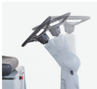
La dirección puede ser ajustada a cinco posiciones para la comodidad del operador.
