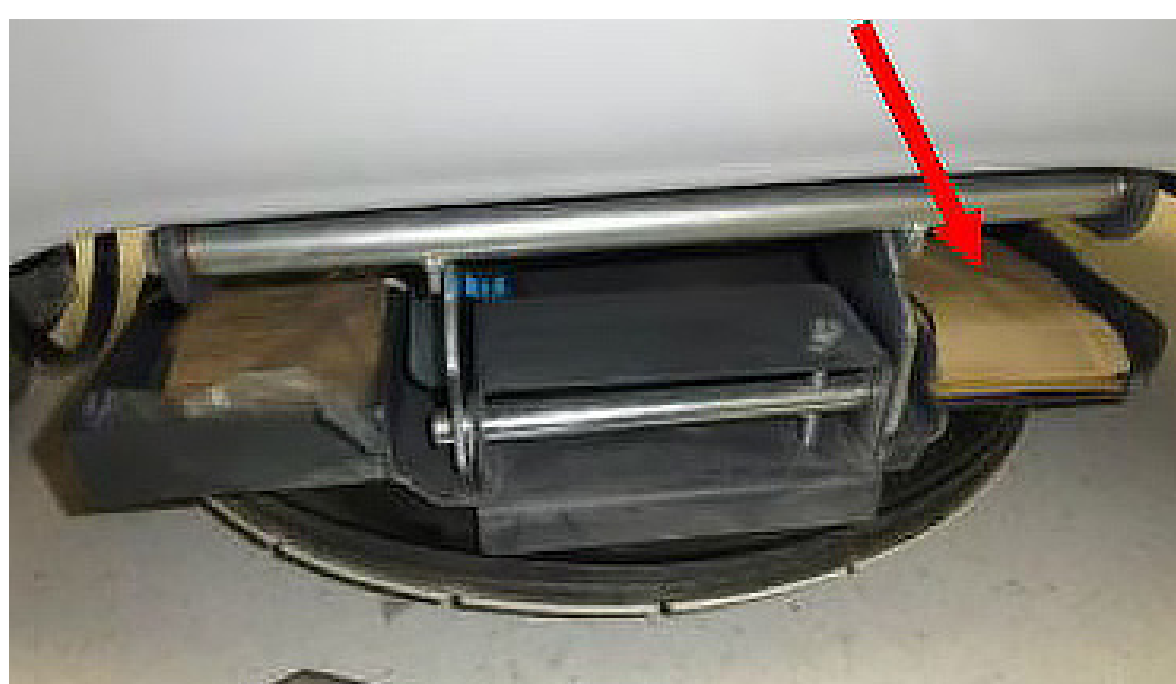
7 Verifica que la bolsa de recolección de polvo esté instalada.
