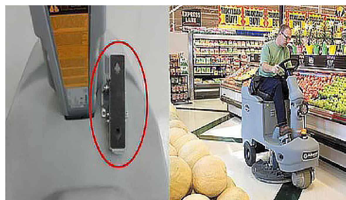
12 Utiliza el control de movimiento del pedal para ir adelante o en reversa. Lleva el equipo al área de trabajo.
