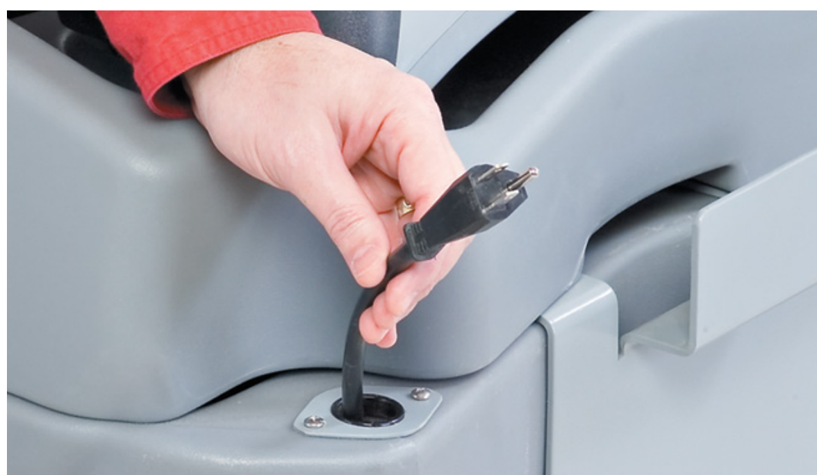
2 Cargador a bordo: Desconecta la batería y almacena el cable dentro del bastidor de la máquina.
