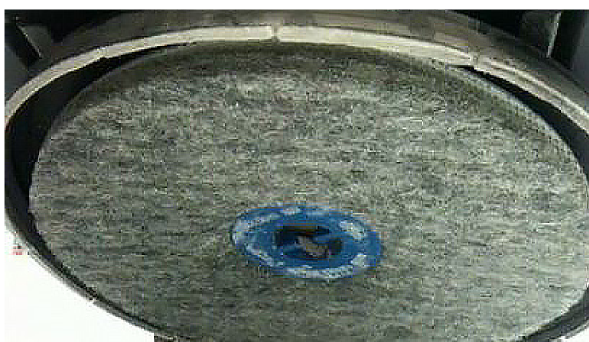
4 Levanta y bloquea la cubierta para inspeccionar el desgaste de la almohadilla.
