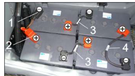
1 Câble de raccordement à la batterie (-) 2 Câble de raccordement à la batterie (+) 3 Câble de raccord court 4 Câble de raccord long
